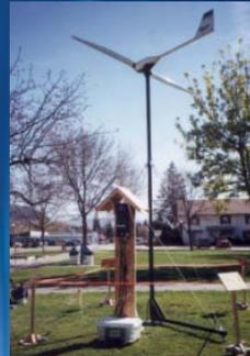
Éolienne de 5 kW de 5 m de diamètre
