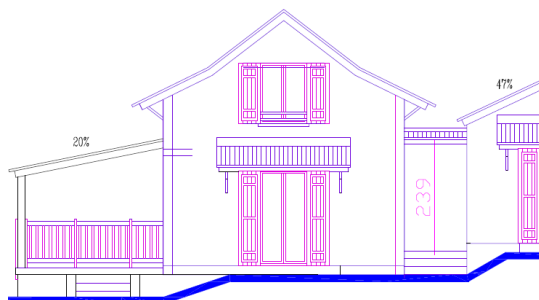
Figure 35: exemple de pare soleil horizontal sur porte d'entrée sur Maison PERENE Zone 3 Ouest. Le débord de toiture en pignon joue le rôle de pare soleil horizontale sur la fenêtre d'étage et la partie haute du pignon (1 er étage)
