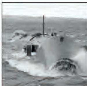
Portant le nom d'un serpent de mer géant de la mythologie grecque, le Pelamis ondule face aux vagues et les convertit en watts.
