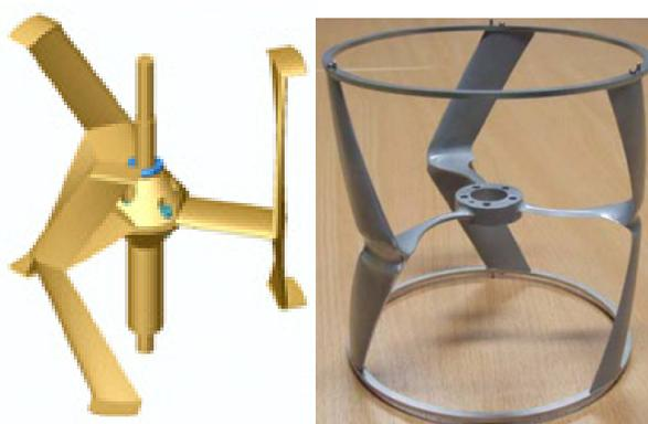
**Figure 8 : Représentation et photo de l'hydrolienne à axe vertical, HARVEST**
