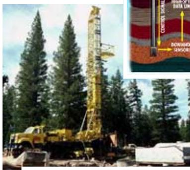
« Truck mounted rig », engin léger permettant la réalisation d'un forage « Slim hole ».
