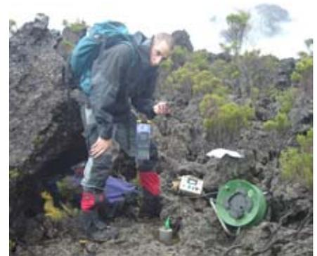
Un opérateur de l'Université utilisant la méthode de la « Polarisation Spontanée » afin de détecter des écoulements de fluides chauds en profondeur..
