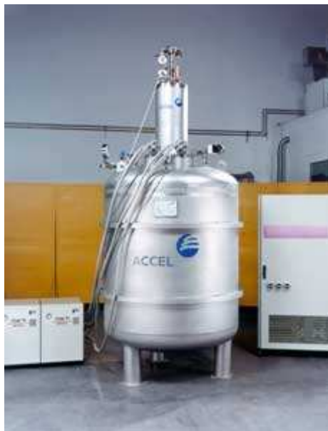
Figure 22 : exemple de SMES de la firme ACCEL ( W_s=600\text{Wh} , P= 200 à 800\text{kW} )
