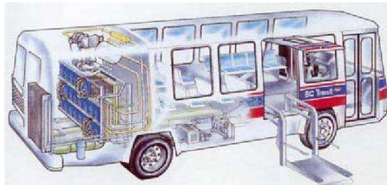
Une telle démonstration était alors plus aisée à réussir qu'un véhicule léger, compte tenu de la place disponible et nécessaire pour une technologie à cette époque très encombrante: en effet, près d'un tiers du volume utile du bus était occupé par la pile et ses périphériques.
