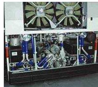
Sur la photo ci-dessus, les ventilateurs du système de refroidissement sont visibles et en dessous on aperçoit le moteur de traction avec le module de pile à combustible (boîtes noires)
