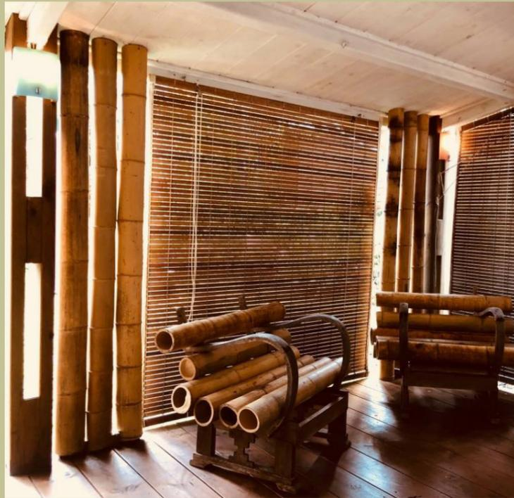
Nous utilisons différentes cannes **séchées et traitées, de bambous d'œuvre de construction**, couramment utilisés pour leurs propriétés mécaniques exceptionnelles. Toutes les coupes de bambou sont traitées anti-termite lors de leur mise en œuvre.
