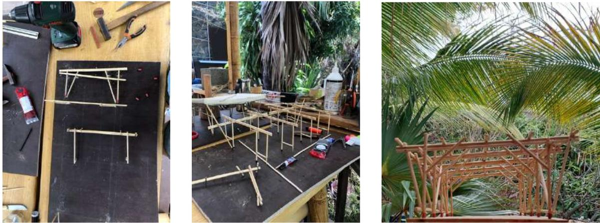
Figure 47 : Maquettes d'étude, échelle 1 :25, construction des fermes à plat sur l'épure (à droite), levage des fermes et ceinturage horizontal (au centre), maquette structure stable (à gauche) (crédits personnel)
