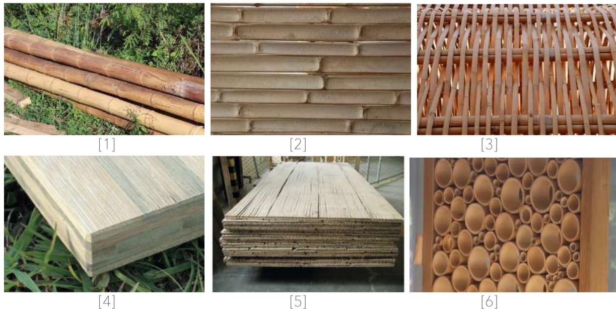
Figure 9 : Cannes entières [1], lattes [2], lattes tressées [3], lamellé collé [4], mats [5], sections transversales [6]
